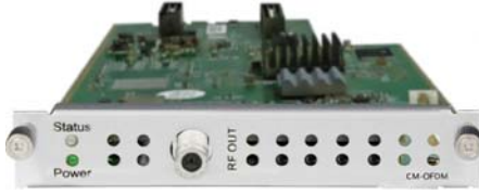
CM2-OFDM-R01/R01A: OFDM Modulation Module
