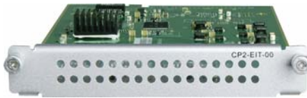
CP2-EIT-00 Processing Module
